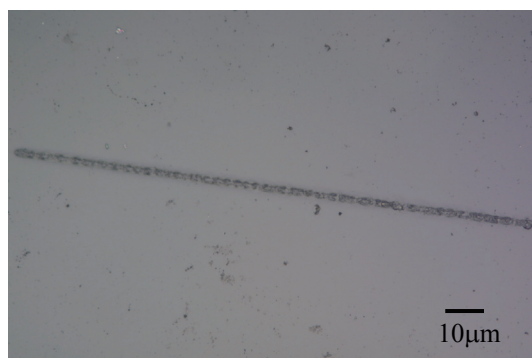
図8 光造形で作成した細線の光学顕微鏡写真
