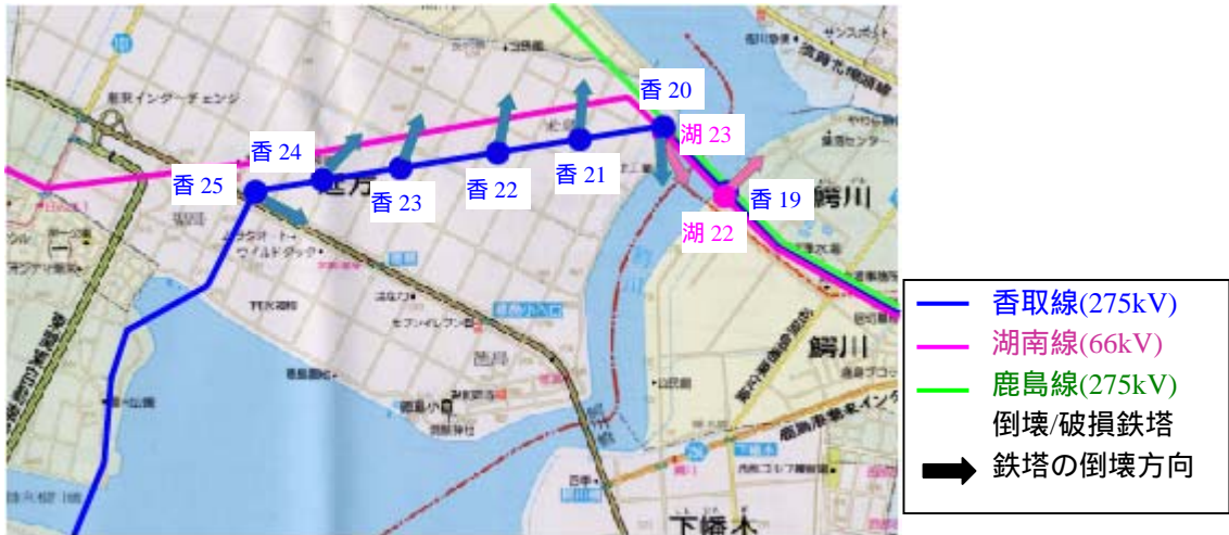
図5 倒壊した鉄塔の位置および倒壊方向
