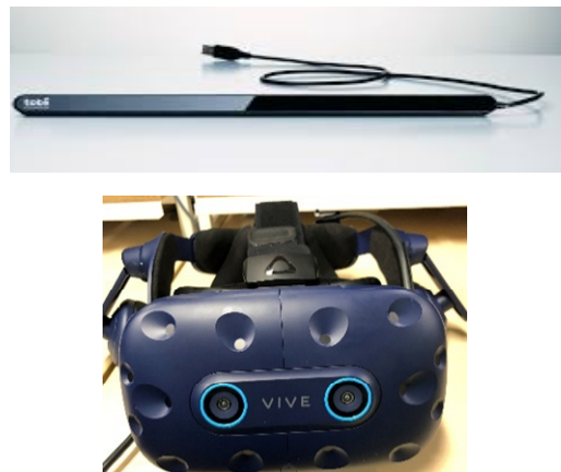
図 3 2 次元視線検出装置と 3 次元視線検出装置
