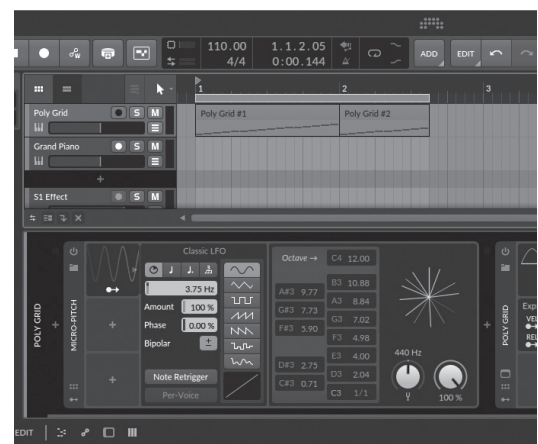
3(b) ピッチや音程を編集できるだけでなく、LFO (低周波発振器) などのエフェクトで変調することもできる。
