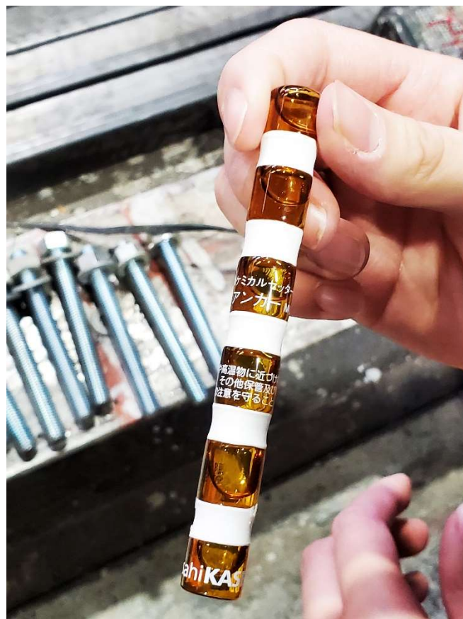
図 19. 実際に用いられたケミカルアンカー（MU-12.旭化成）
