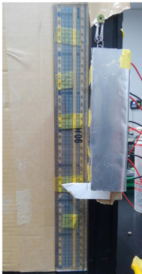
図 6 収縮量測定器
