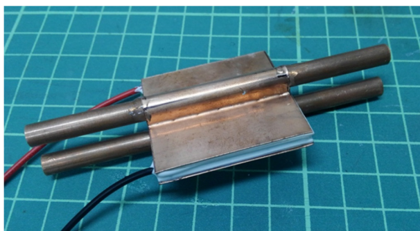
図 10 製作した釣り糸人工筋肉制御装置
