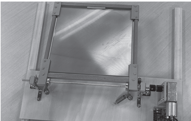
図9. 上下及び角度の調整が電動で行える機構
