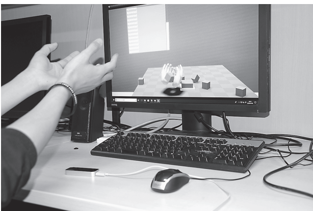
図1 Leap Motionの外観。テーブルの上に置かれた、マウスの左側にある装置がLeap Motionである。
