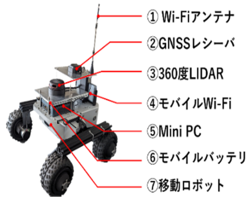
図5 屋外用ロボットの構成
