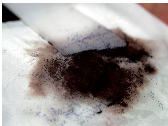
図10 新岩絵具の群青と漆を混合後、ヘラをテレピン油で洗浄したところ。岩群青の粒子が見られる。
