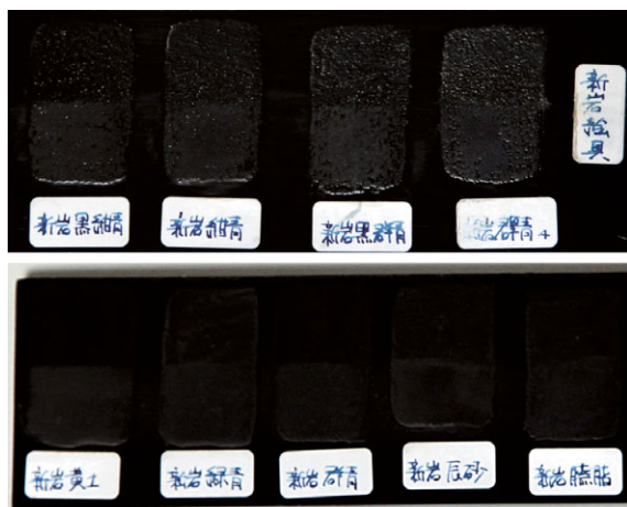
図11 新岩絵具と漆を混合して板に塗布し、乾燥後に下半分を研いだもの。研ぎの有り無しに関わらず、いずれも色相は暗く、色味が見られない。
