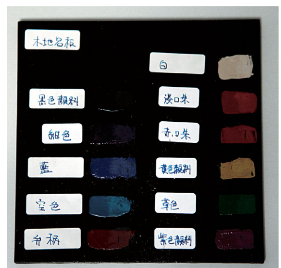
図15 レーキ顔料と漆の混合、及び手板への塗りと研ぎを行ったもの。他の色材と混合した色漆に比べ、色相が明確に見分けられる。
