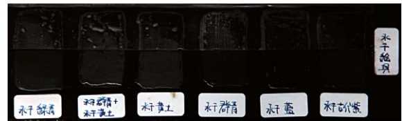
図12 水干絵具と漆を混合して板に塗布し、乾燥後に下半分を研いだもの。色相が暗く、色味が見られない。
