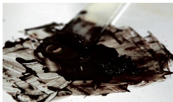
図7 漆と混合した際に、小片同士で固着した丹。
