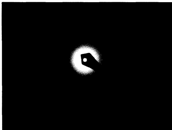
図8 200°Cで熱処理した場合の電子線回折
